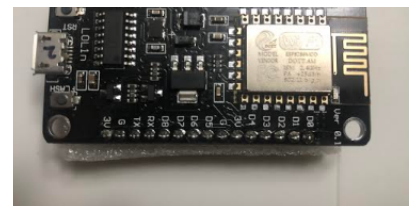
Figura 5. Tarjeta ESP8266. Fuente: Propia
